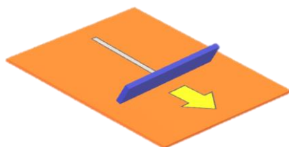
スクリーン印刷でフィルム上に2次元配線形成
